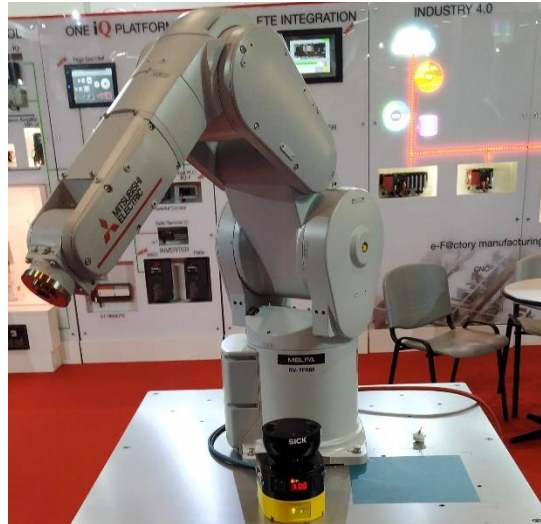
Figura 4 - Manipulador da Mitsubishi com um Laser de Segurança Sick
