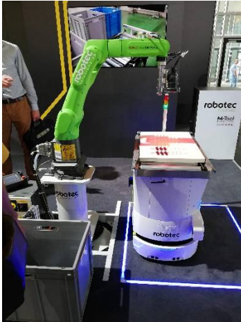
Figura 5 Demonstração de um sistema de pick and place colaborativo entre o AGV e um manipulador colaborativo
