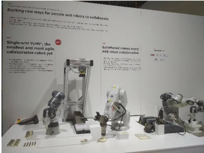
Figura 15. Extensión en el controlador ABB para operación colaborativa en robots de baja capacidad de carga
